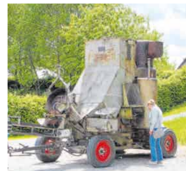
Kürnbach zeigt im Freien kuriose Geräte wie diesen automatischen Kartoffeldämpfer von 1967. Darin kochten die Bauern früher die Futterkartoffeln für die Schweinemast. Denn die Tiere vertrugen gegarte besser als rohe. FOTO: MUSEUMSDORF KÜRNBACH
